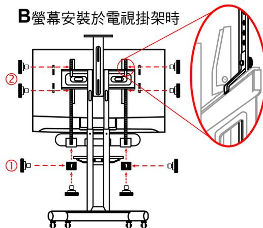
1. 將MS-10與電視掛載支架鎖上螺絲固定。
